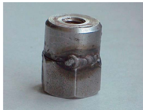
Bild 4: „Repariertes“ Schmelzelement einer PROTEGO® Dauerbrandsicherung
