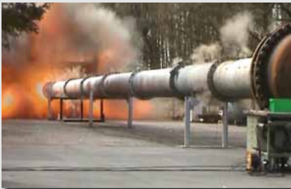
Explosionsversuch mit DN 800 Rohrleitung
